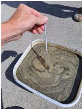
*Abbildung 1 Der Güllehydrometer misst den Trockensubstanzwert im Güllegesamt-komplex zur betrieblichen Justierung der Gülle auf 1:1 Verflüssigung: Im Moment wird eine schnelle jährliche Erfassung in Absprache mit der HBLFA Raumberg-Gumpenstein durch Tierzuchtverbände ab 2025 geplant.*
